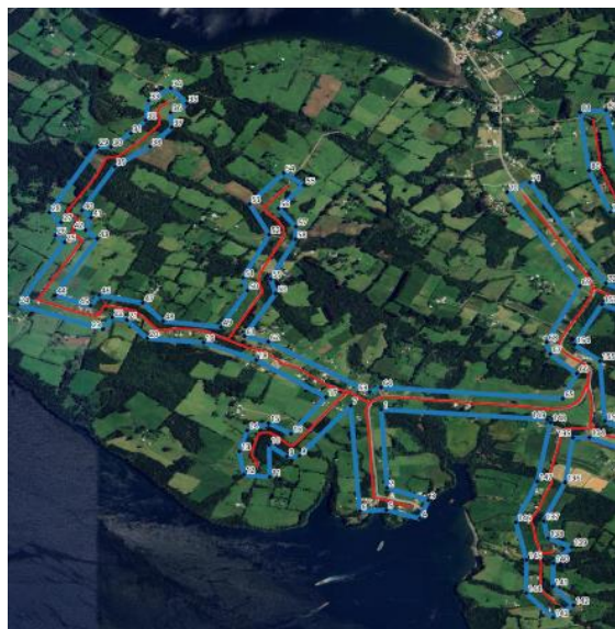
Figura 1 Ejemplo de área de servicio criterio de 50 m a cada lado del eje por donde pasa la red
